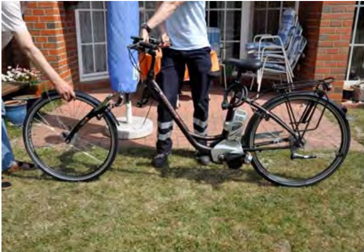
Abbildung 10: Abriss der Vorderradgabel nach Kollision eines Pkw (ca. 25 km/h) gegen die linke Seite des Vorderrades (ca. 15 km/h)
