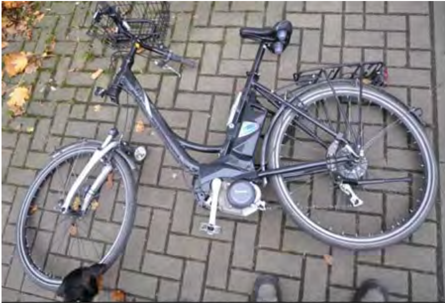
Abbildung 9: Bruch des Standrohrs nach frontaler Kollision (ca. 15 km/h) mit Seite eines rollendem Pkw (ca. 5 km/h)
