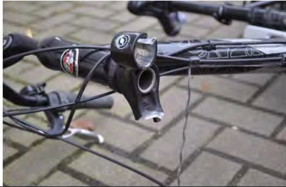
Abbildung 9: Bruch des Standrohrs nach frontaler Kollision (ca. 15 km/h) mit Seite eines rollendem Pkw (ca. 5 km/h)
