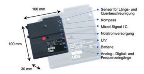
Der UDS verfügt über Beschleunigungs-Sensoren, einen Kompass, eine eigene Notstromversorgung und eine Uhr sowie eine Bedientaste, einen Prozessor und eine Schnittstelle zum Fahrzeug sowie eine Schnittstelle zum Datenauslesen.
