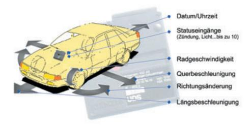
Die Sensoren von UDS erfassen die Längs- und die Querbeschleunigung sowie die Richtungsänderungen des Fahrzeugs. Zusätzlich registriert das Gerät die Fahrzeuggeschwindigkeit.
