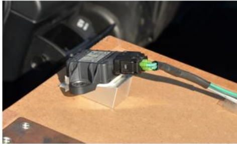
Beschleunigungsmesser In waagerechter Position fixiert im Fahrzeug über die ISOFIX-Verankerungspunkte
