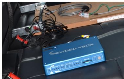
Rekorder (Video VBOX Racelogic ) speichert die Signale der Kamera, des Beschleunigungssensors (10 Messungen/Sek) und der GPS Antenne auf einer Speicherkarte
